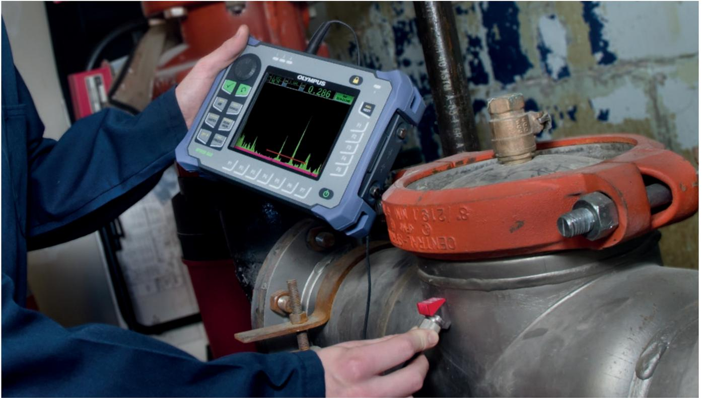
EPOCH 650数字式超声探伤仪将奥林巴斯领先行业的常规探伤性能及仪器小巧便携、操作直观的特点融合在一起。这款探伤仪具有高效的菜单功能和快捷键访问功能，为检测人员提供了一种操作起来极为简便的质量上乘的缺陷检测平台。
