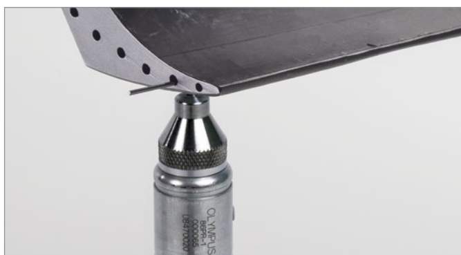
使用目标钢线对涡轮叶片进行测量
