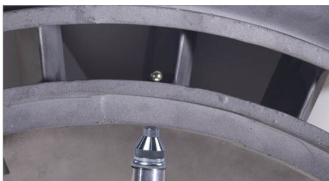
对24.1毫米的 航天器铸件进行测量
